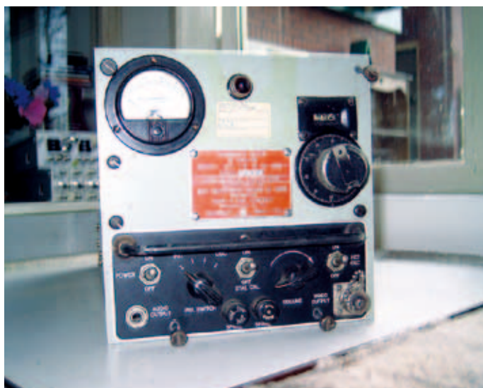
Foto 10: Testset TS-186D/UP max. 10 GHz
