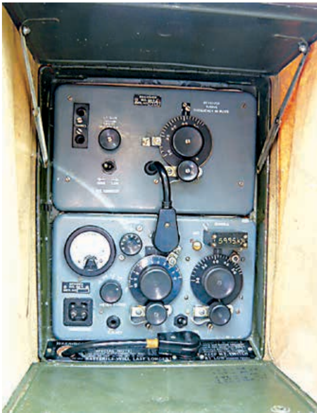
Foto 1: Een fraaie WS68T, zie de mogelijkheid voor kristalstuning van de zender
