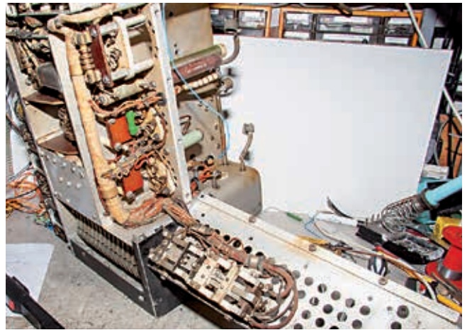
Foto 9: De blauwe verbindingsdraad voor 400 V voor het schermrooster van de 813
