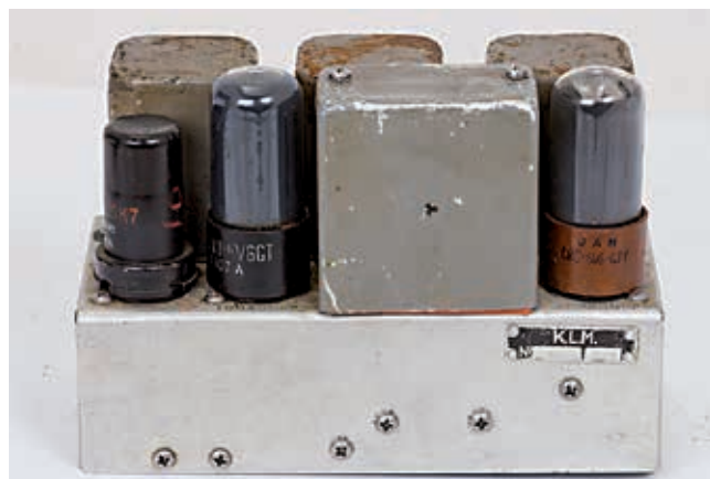
Foto 6: De speechamplifier, links was ook een 6V6 geplaatst
