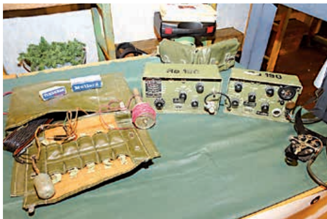
Foto 5: De Zweedse draagbare HF-installatie RA 190
