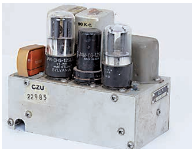
Foto 7: De MCW/CFI-unit met oranje 200 kc/s kristal
