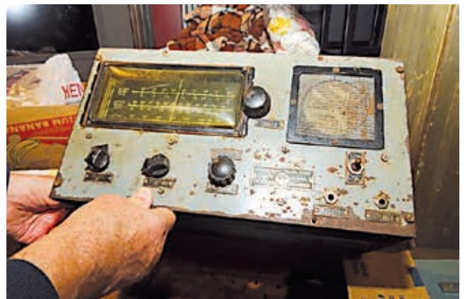
Foto 14: Een antieke Engelse scheepsontvanger, wel roestig maar nog wel op te knappen
