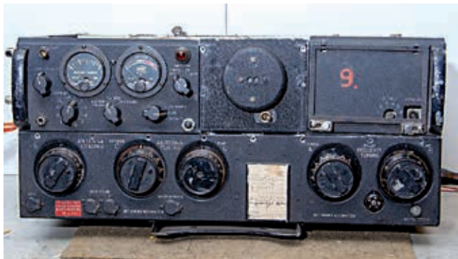
Foto 1: De ART-13 met de 110 kristal-unit en de rode "9" op de speechamplifier Afbeelding 1
