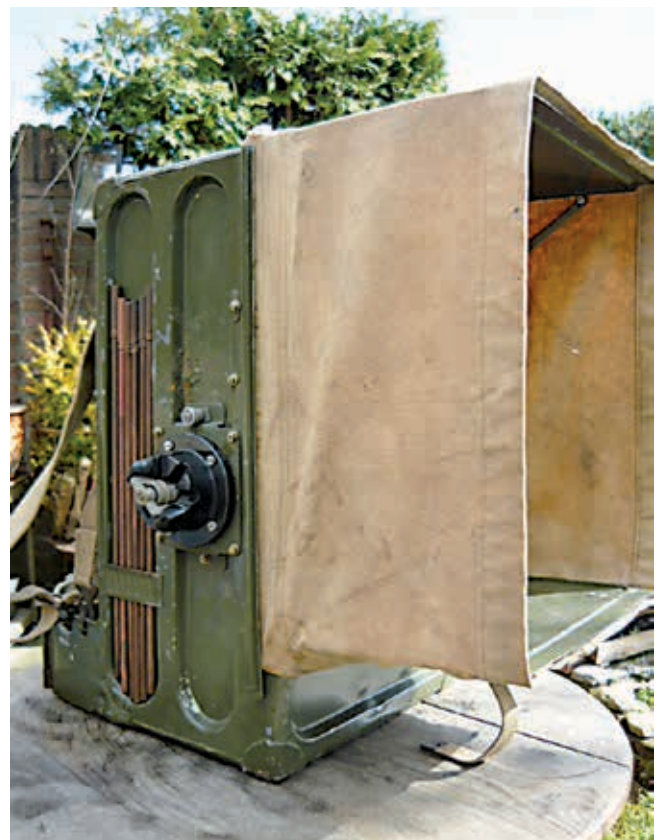
Foto 2: De in enkele standen te verdraaien antennevoet van de WS68
