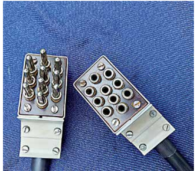
Foto 5: Detail van de kabeluiteindes aan de stekkerkant en de stekkerbussenkant
