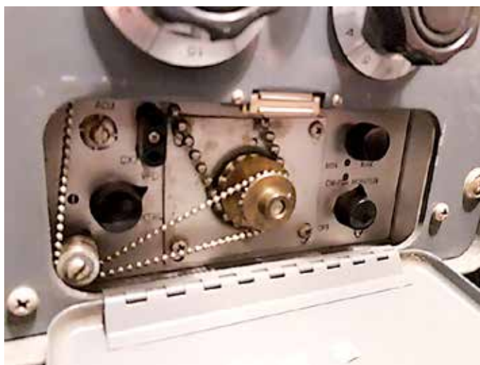
Foto 5: Aandrijving van de bandschakelaar
