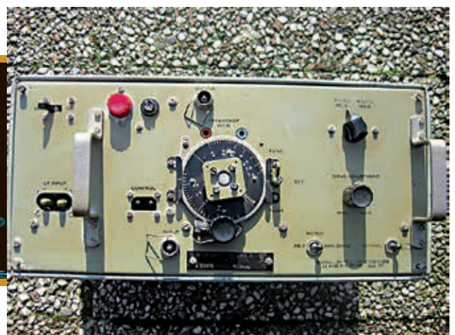
Een anode/schermrooster modulator voor de high power van de WS19
