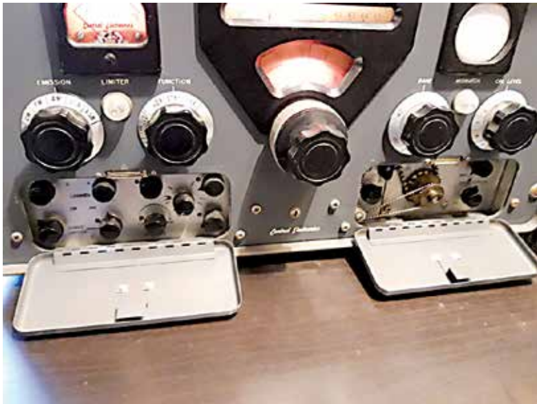
Foto 6: De "set and forget" controls achter de klepjes op de frontplaat
