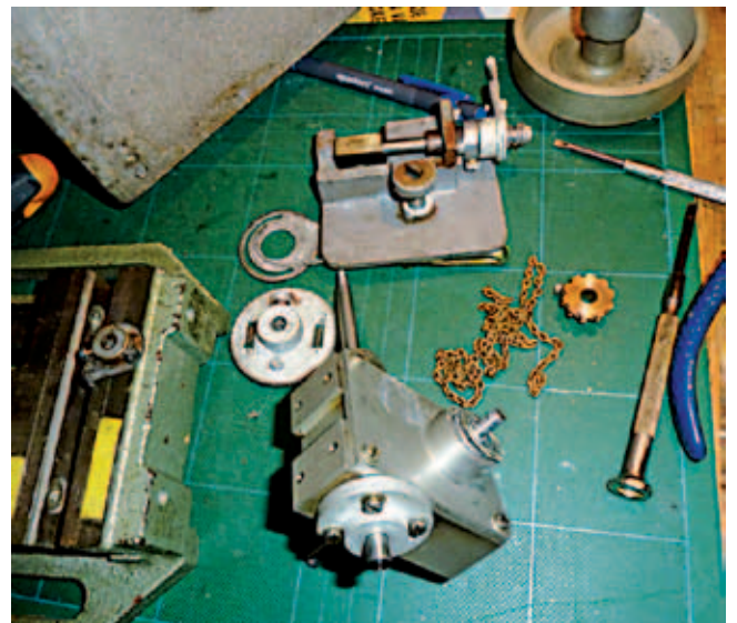
Foto 9: Enkele maar lang niet alle losse onderdelen van de vertraging en aandrijving. In het blok zit het worm/tandwiel. Dat geheel moet uit elkaar om het gespannen tandwiel weer op spanning te zetten. (pas op met volgorde van ringetjes, kogeltjes, lagertjes, veertjes, ...) Er zijn nergens merktekentjes in welke stand je het één en ander in elkaar moet steken.
