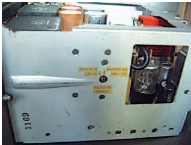
Foto 2: Schakelaar inwendig van type AM-598A/U
