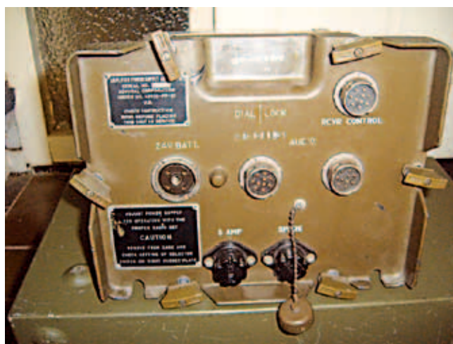
Foto 1: Vooraanzicht van type AM-598A/U, let op de waarschuwing
