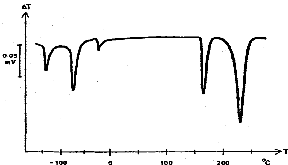
Abb. 1. DTA-Aufheizkurve von \text{NH}_4\text{CF}_3\text{SO}_3 . \Delta T = 0.05 \text{ mV} \cong 1.25^\circ\text{C} .
