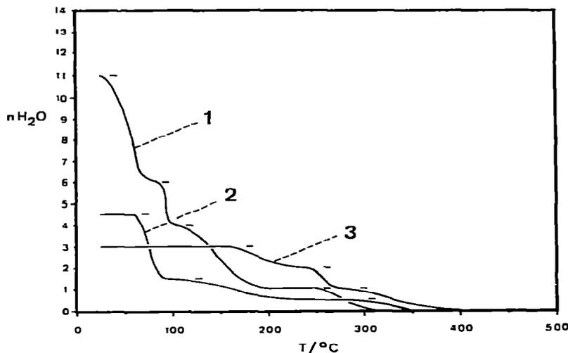
Fig. 1. Dehydration of uranyl arsenate hydrates. 1,  $(\text{UO}_2)_3(\text{AsO}_4)_2 \cdot 11 \text{H}_2\text{O}$  or  $3 \text{UO}_3 \cdot \text{As}_2\text{O}_5 \cdot 11 \text{H}_2\text{O}$ ; 2,  $\text{UO}_2\text{HAsO}_4 \cdot 4 \text{H}_2\text{O}$  or  $\text{UO}_3 \cdot 0.5 \text{As}_2\text{O}_5 \cdot 4.5 \text{H}_2\text{O}$ ; 3,  $\text{UO}_2(\text{H}_2\text{AsO}_4)_2 \cdot 1 \text{H}_2\text{O}$  or  $\text{UO}_3 \cdot \text{As}_2\text{O}_5 \cdot 3 \text{H}_2\text{O}$ .
