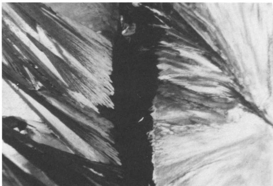
Fig. 5. Au cours du chauffage, fusion de l'eutectique et apparition d'un couloir entre les deux constituants cristallisés, observés dans le même champ du microscope que précédemment.
