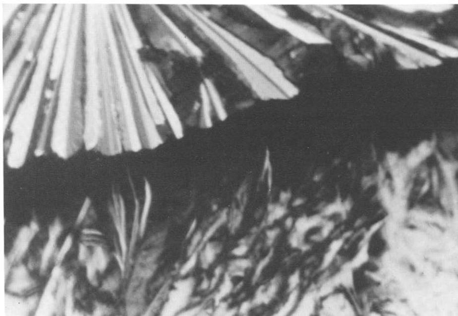
Fig. 2. Au cours du chauffage, fusion de l'eutectique et apparition d'un couloir entre les deux constituants cristallisés observés dans le même champ du microscope que précédemment.
