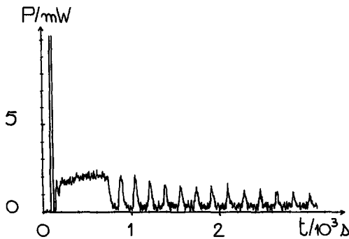
Fig. 1. Réaction de Belousov-Zhabotinskii en système fermé: (A) allure du thermogramme expérimental s(t) ; (B) évolution de la puissance développée en fonction du temps. Déconvolution réalisée par la méthode de la transformée en Z. Documents aimablement fournis par C. Rey, et al. [32].
