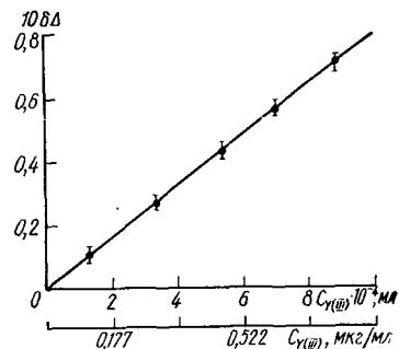
Калибровочный график для определения микроколичеств иттрия (III) (концентрация  $MoO_4^{2-}$  —  $5 \cdot 10^{-3}$  M, этилгидразина —  $5 \cdot 10^{-2}$  M; pH 1,4;  $t=25^\circ$ ).
