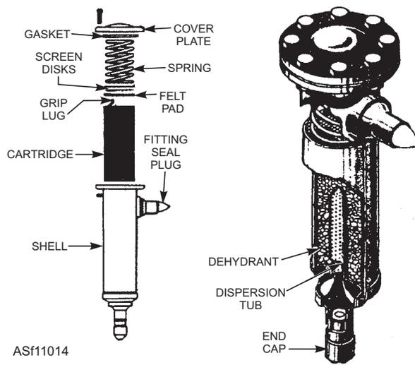
Figure 11-14.—Drier-strainer (dehydrator).
