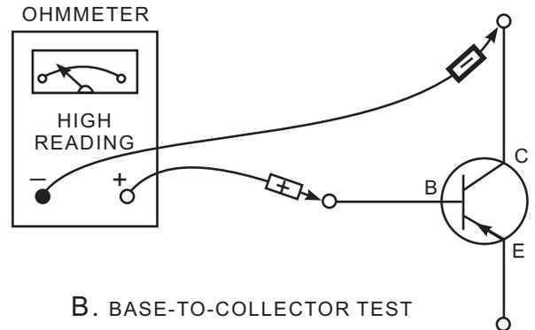
B. BASE-TO-COLLECTOR TEST
