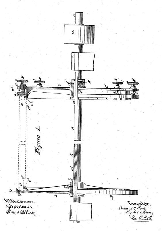
LATHE FOR TURNING POLYGONAL FORMS.
